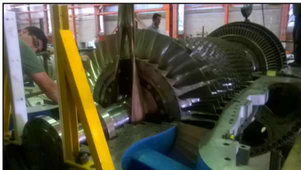
شکل ۵- عملیات مونتاژ نهایی توربین MGT-40
