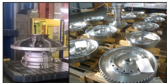
شکل ۳- دیسکهای ماشینکاری شده روتور و پوسته خروجی کمپرسور در حال پین زنی
