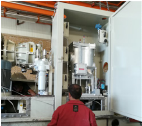
شکل ۷- عملیات پکیجینگ شامل نصب آیتمهای مختلف بر روی اسکید (پلنوم، شیر و کابینت سوخت و توربین...)
