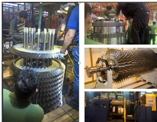
شکل ۴- فرایندهای مونتاژ و بالانس روتور MGT-40
